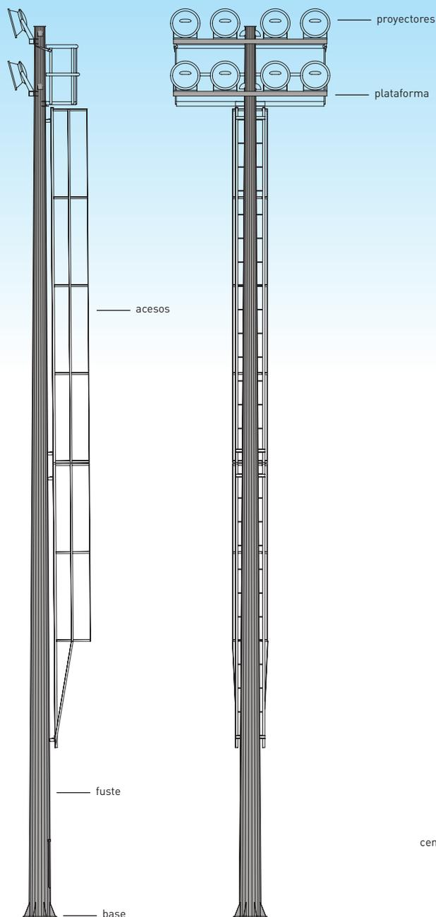
El modelo URBA H esta compuesto por un fuste recto donde, en punta es acoplada la plataforma y las crucetas para los proyectores. El acceso a la plataforma puede ser a través de escalera o elevador. Alturas: 15,18,20,25,30 mts.
